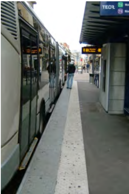
TEOR kantstensangöring med "gap-filler" på fordonet
