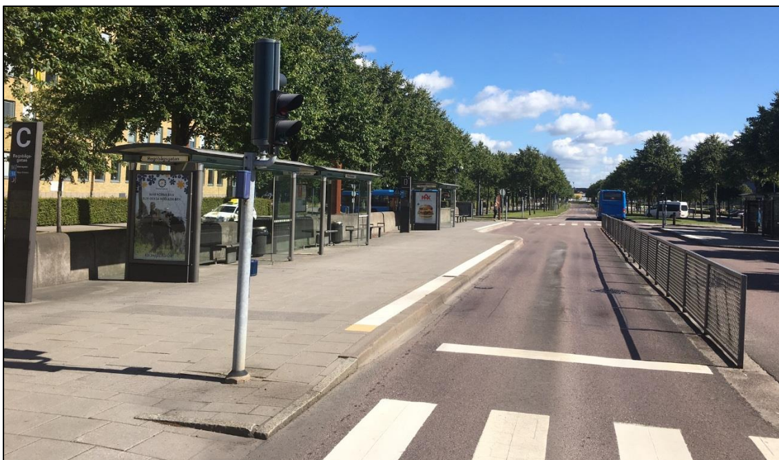
Figur 5.2. Bilden visar hållplats Lindholmsallén i Göteborg med förskjutna hållplatslägen som medger fri in- och utfart för den prioriterade linjen.
