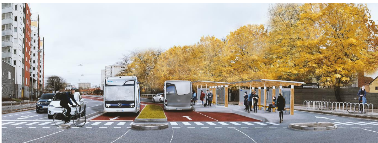
Figur 11. Exempel på möjlig hållplatsutformning vid både BRT- och regionbusshållplats (skiss/montage av Anders Lind)
