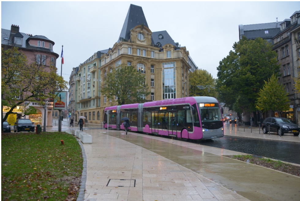
Figur 7-1 I bild en variant av busstillverkaren Van Hools ExquiCity som är ett exempel på buss som utformats för att likna en modern spårvagn med större glaspartier, dolda hjulhus. Busstypen finns som normalbuss, led buss och dubbelled buss. Foto: PG Andersson
